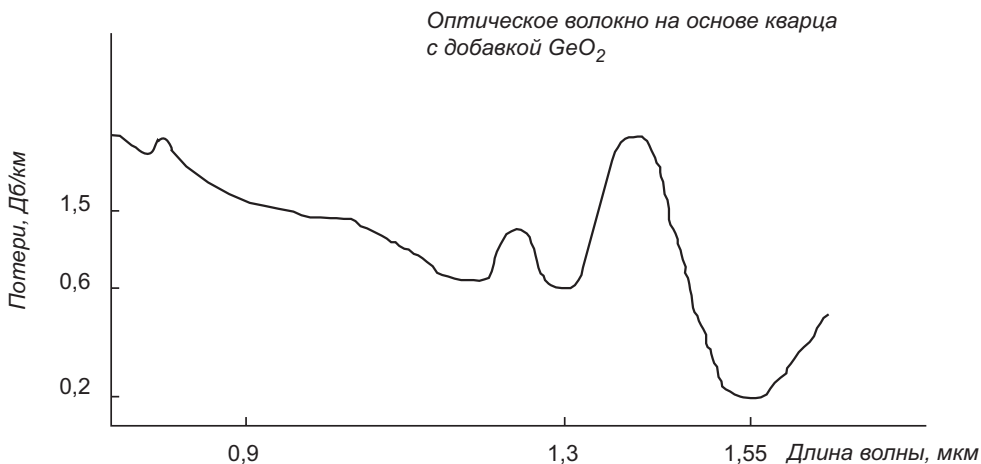
Рис. 11.3. Спектр пропускания оптического волокна на основе кварца [8]
