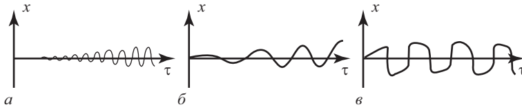
Рис. 4.22. Осциллограммы, иллюстрирующие характер установления и форму автоколебаний при различных параметрах \mu = 0,1 (а); \mu = 1 (б); \mu = 10 (в) [22]
