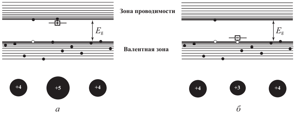
Рис. 1.2. Энергетические схемы полупроводников n -типа (а) и p -типа (б)
