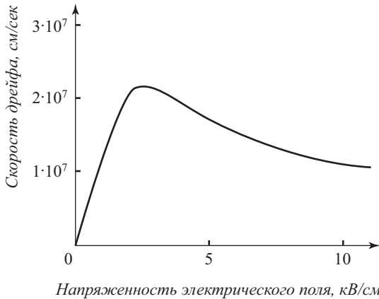
Рис. 9.4. Зависимость скорости дрейфа от напряженности поля для GaAs
